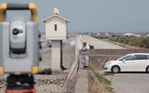
有明川にそそぐ、矢部川のロボティック横断測量の様子
